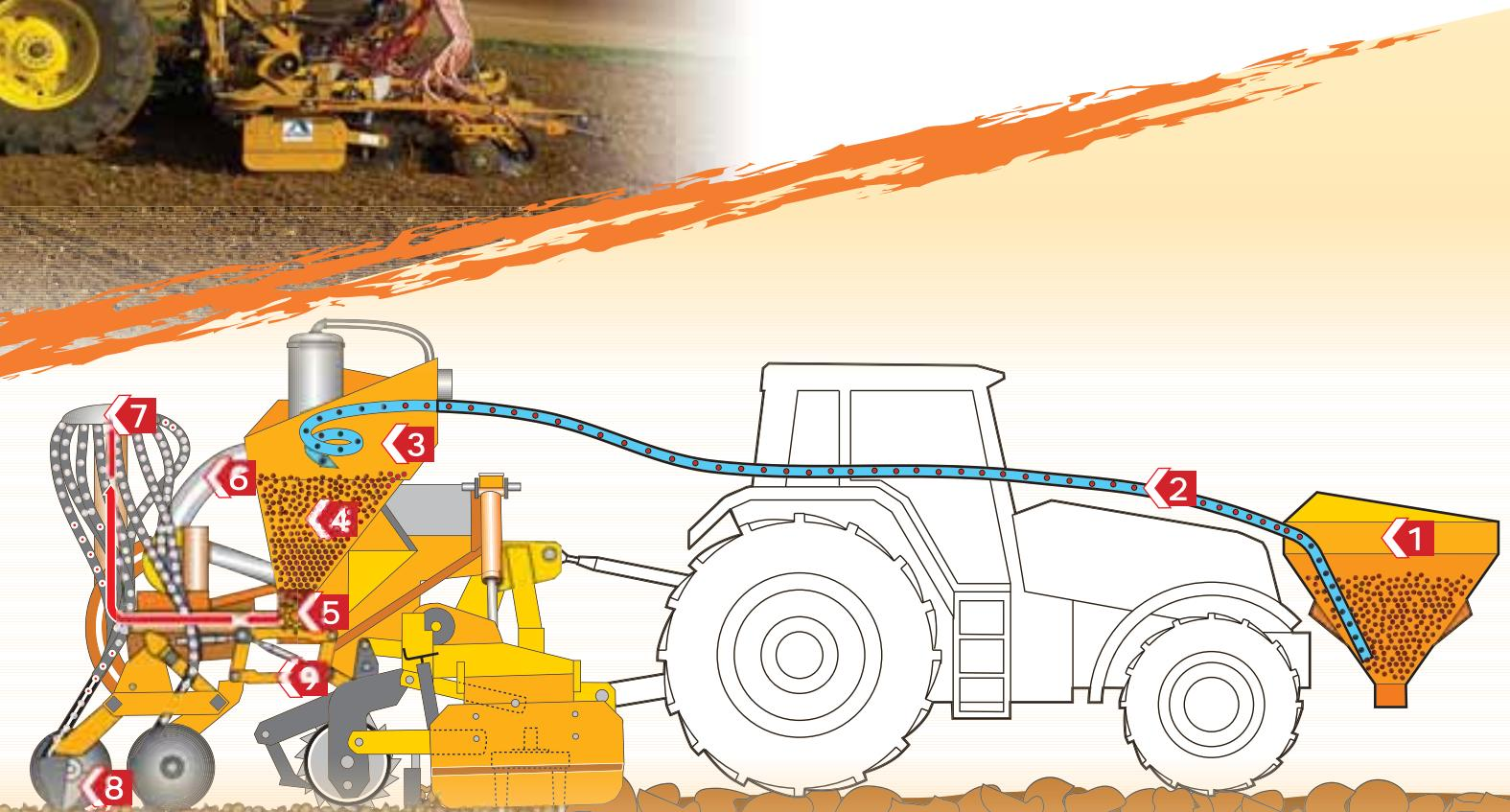
➤1 Tramoggia anteriore non necessita di nessun particolare attacco e/o collegamento idraulico meccanico elettrico /
